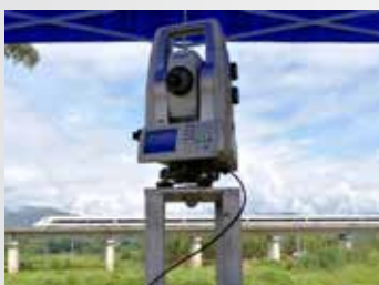
高铁桥梁监测
